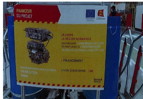
Ce moteur nouvelle génération est un moteur synchrone à rotor bobiné, une technologie sur laquelle Renault mise depuis dix ans qui offre un meilleur rendement que le moteur à aimants permanents. L'absence de terres rares limite son impact environnemental et les coûts de production.
